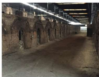
窯入れ後、約一週間1200度で炭化させる
