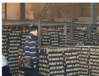
乾燥・圧縮成形をさせてオガ炭のもとになるオガライトを作成
